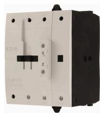
Contattore di potenza, A 4 poli, Comando in corrente alternata: 200 A, RAC 24: 24 V 50/60 Hz, Morsetti a vite
