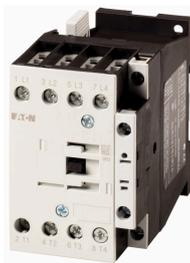
**Contattore di potenza, A 4 poli, Comando in corrente continua, AC-1: 32 A, 1 contatto NA, RDC 24: 24 - 27 V DC, Morsetti a vite**
