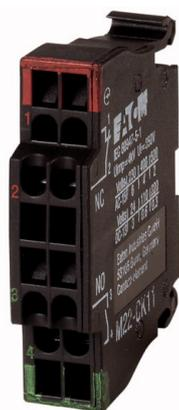
**Elemento di contatto, Cage Clamp, Fissaggio frontale, 1 contatto NA, 1 contatto NC, 24 V 3 A, 220 V 230 V 240 V 4 A**
