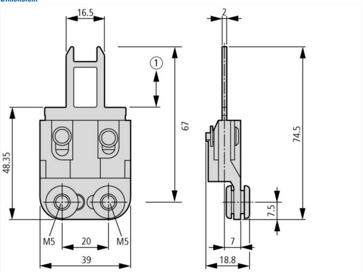
Fissaggio consentito solo con viti di fissaggio M5 e rondelle a U conformemente a DIN EN ISO 7093.
