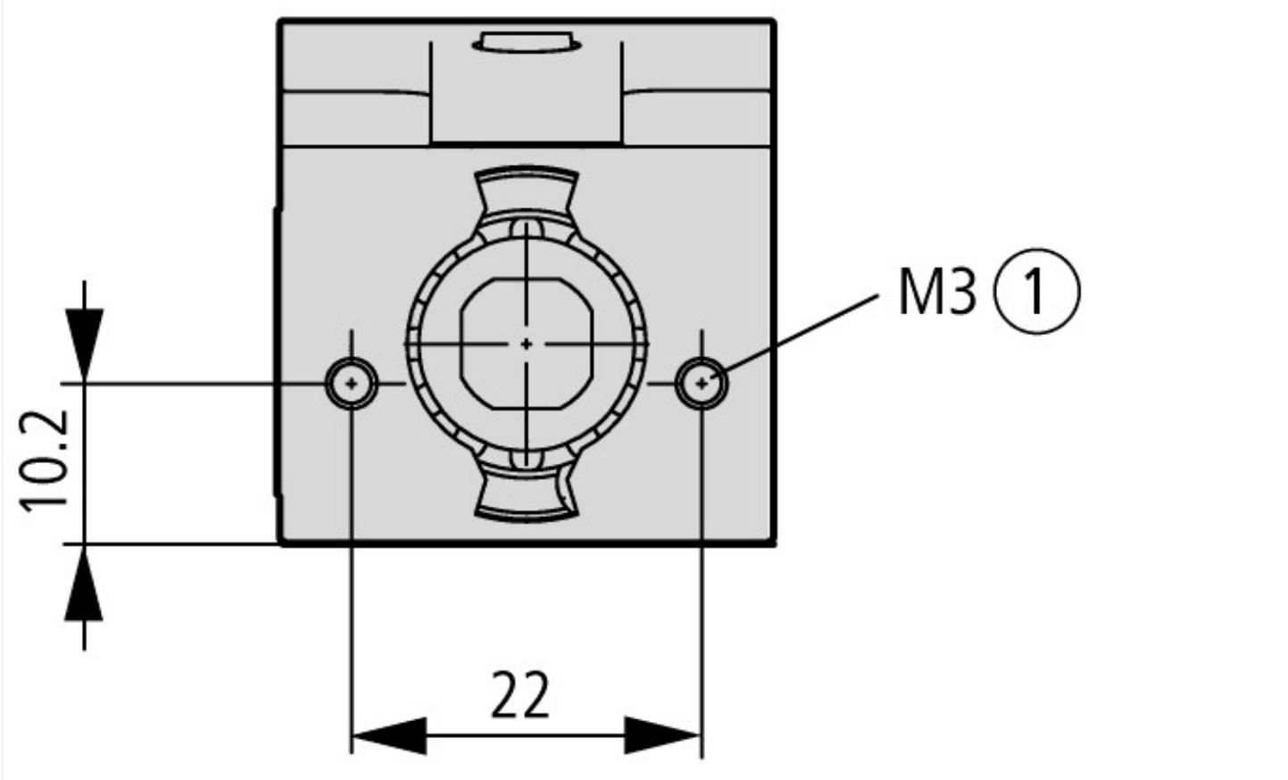
① Profondità di avvitamento max. 12 mm
