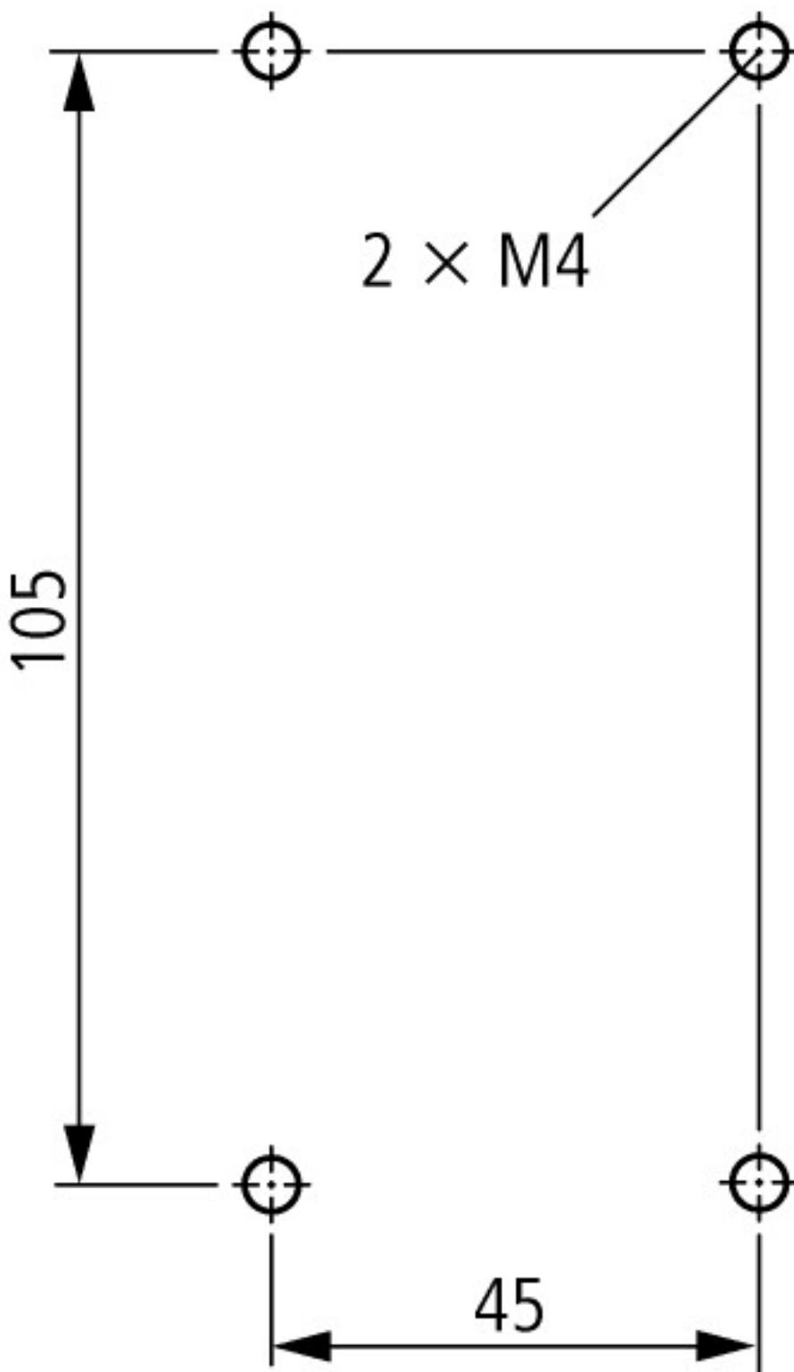
Distanza di sicurezza minima laterale rispetto a materiali conduttivi: 6 mm
