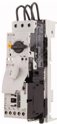
Avviatore diretto, 3p, 0.25kW/400V/AC3, 100kA, +adattatore per sbarre
