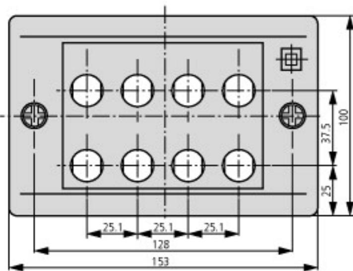
Foro di fissaggio:  $2 \times \varnothing 4,5$  mm
