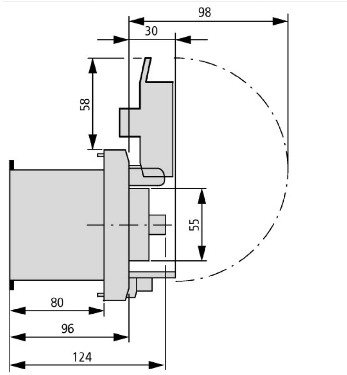
Custodia in materiale isolante per montaggio ad incasso
