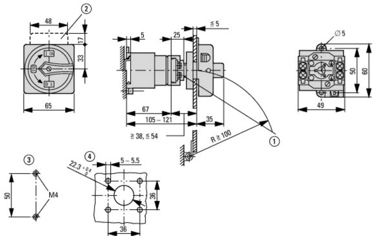
① Prolunga dispositivo di bloccoporta e asse possibile con ZAV-T0 + ZVV-T0, max.  $4 \times 25 = 100$  mm
