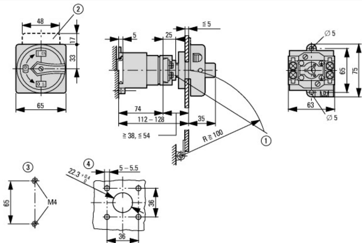
① Prolunga dispositivo di bloccoporta e asse possibile con ZAV-T0 + ZVV-T0, max.  $4 \times 25 = 100$  mm
