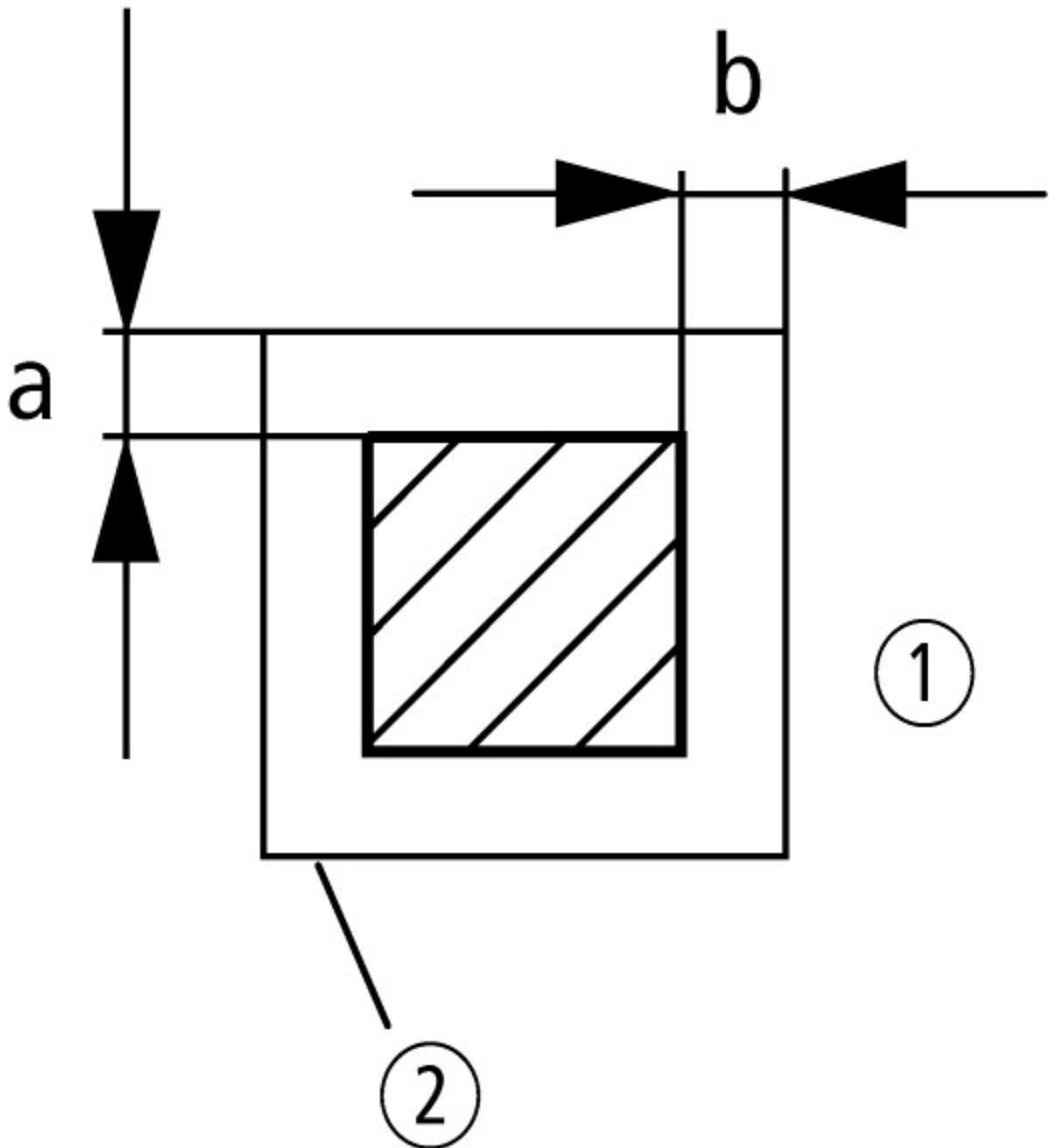
① Distanze di montaggio a e b: 4 mm
