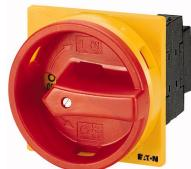
**Interruttori generali, T3, 32 A, da incasso, 4 Unità costruttiva/e, a 8 polo, Funzione di arresto d'emergenza, con maniglia rotativa rossa e anello di blocco giallo, lucchettabile in posizione 0**
