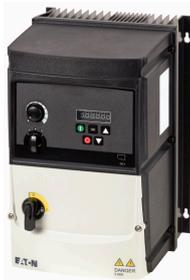
**Convertitore di frequenza, 400 V AC, trifase, 24 A, 11 kW, IP66/NEMA 4X, Filtro soppressore radiodisturbi, Chopper frenatura, Display a 7 segmenti, Elementi di comando locali, Protezione scheda elettronica aggiuntiva, Resistente ai raggi UV, FS3**
