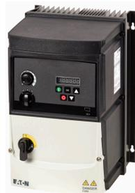
**Convertitore di frequenza, 230 V AC, monofase, 15.3 A, 4 kW, IP66/NEMA 4X, Filtro soppressore radiodisturbi, Chopper frenatura, Display a 7 segmenti, Elementi di comando locali, Protezione scheda elettronica aggiuntiva, Resistente ai raggi UV, FS3**
