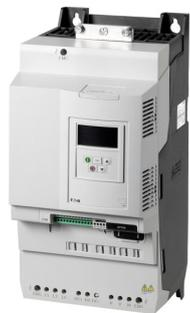
**Convertitore di frequenza, 400 V AC, trifase, 61 A, 30 kW, IP20/NEMA 0, Filtro soppressore radiodisturbi, Protezione scheda elettronica aggiuntiva, Induttanza circuito intermedio, FS5**
