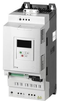
**Convertitore di frequenza, 230 V AC, trifase, 30 A, 7.5 kW, IP20/NEMA 0, Filtro soppressore radiodisturbi, Chopper frenatura, Protezione scheda elettronica aggiuntiva, Display OLED, FS4**
