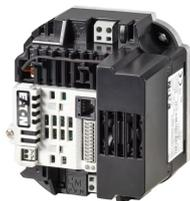
**Convertitore di frequenza, 230 V AC, monofase, 7 A, 1.5 kW, IP20/NEMA0, Filtro soppressore radiodisturbi, Protezione scheda elettronica aggiuntiva, FS1B**
