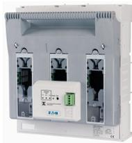
**Sezionatore NH 3p collegamento piatto M10 max. 300 mm<sup>2</sup>; sistema sbarre 60 mm; controllo elettronico dei fusibili; NH3**
