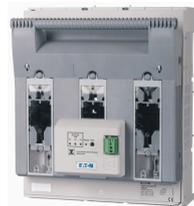
**Sezionatore NH 3p morsetto a mantello 95 - 300 mm<sup>2</sup>; piastra di montaggio; controllo elettronico dei fusibili; NH3**
