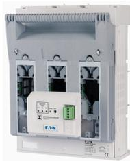
**Sezionatore NH 3p morsetto a mantello 95 - 300 mm<sup>2</sup>; sistema sbarre 60 mm; controllo elettronico dei fusibili; NH2**
