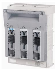
**Sezionatore NH 3p collegamento piatto M10 max. 240 mm<sup>2</sup>; sistema sbarre 60 mm; NH2**
