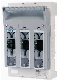
**Sezionatore NH 3p collegamento piatto M10 max. 150 mm<sup>2</sup>; sistema sbarre 60 mm; unità di monitoraggio fusibile Light; NH1**
