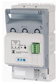
**Sezionatore NH 3p collegamento piatto M8 max. 95 mm<sup>2</sup>; piastra di montaggio; controllo elettronico dei fusibili; NH000 & NH00**
