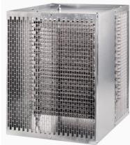
Reostato di frenatura, IP20, 47 Ω, 5.1 kW, utilizzo con: DC1, DA1, DL1, DG1, SVX, SPX
