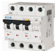
**Interruttore magnetotermico differenziale, 20 A, 300 mA, caratteristica di intervento interruttore magnetotermico: C, 3p+N, caratteristica di sgancio differenziale: AC**
