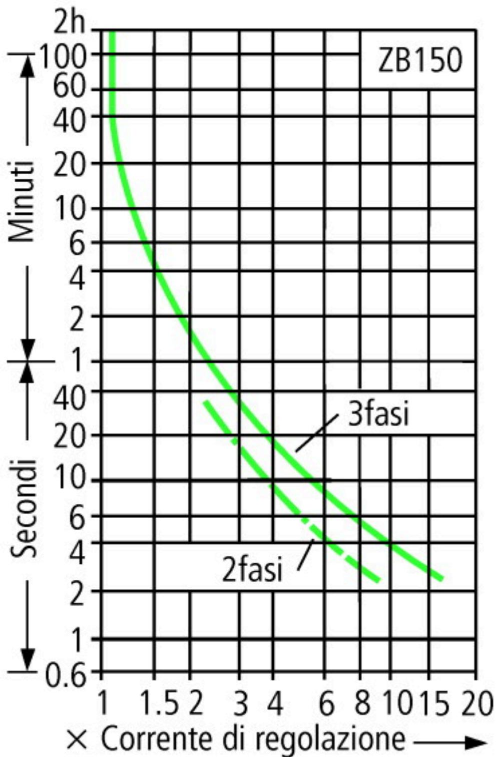
Queste caratteristiche d'intervento indicano i tempi di intervento in funzione della corrente di taratura, esse rappresentano i valori medi ricavati a freddo ad una temperatura di 20 °C. Tempo di sgancio a seconda della corrente di intervento.
