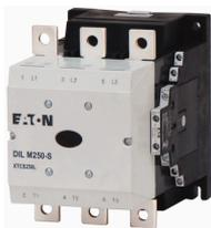
Contattore di potenza, 3p+2NA+2NC, 132kW/400V/AC3
