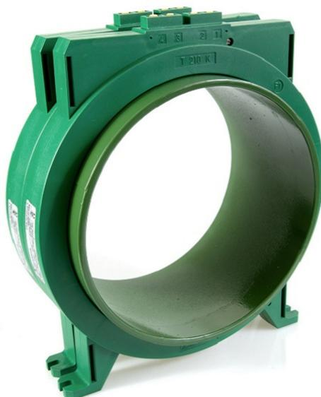
Negli impianti di grosse dimensioni, quando si utilizzano sbarre oppure sono presenti molti cavi, può capitare di non riuscire a centrare i conduttori attivi e di passare in prossimità della carcassa interna del toroide. Ciò non rappresenta una corretta installazione in quanto, in caso di spunti elevati o elevate correnti di carico, si può incorrere in una lettura non corretta della corrente differenziale e di conseguenza in scatti intempestivi.
