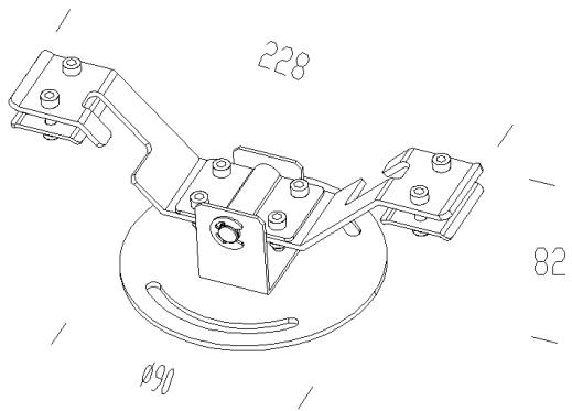
Corpo in acciaio inox AISI 304. Per l'applicazione su funi e cavi in acciaio.
