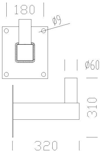
Corpo in acciaio tropicalizzato con piastra di fissaggio. Permette l'installazione a parete.
