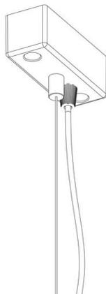
Completa di cavetto in acciaio (L = 100 cm) con dispositivo per regolazione millimetrica e cavo di alimentazione. Carico max.20Kg. Versione a 5P per cablaggio EM e DIMM DALI.
