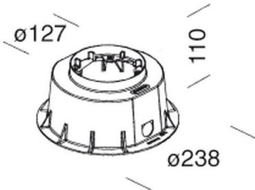
in nylon f.v. Da utilizzare per incassare Microfloor nel terreno
