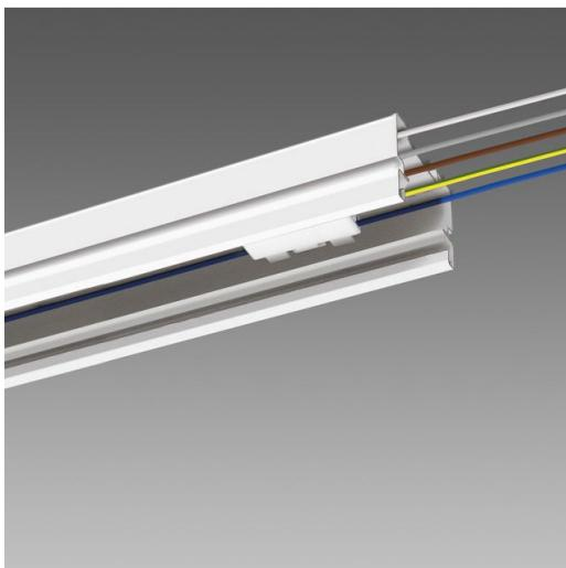
Struttura portante adatta per la composizioni di file continue con apparecchi della serie Techno System o miste. Installazione semplice e veloce a parete, soffitto o a sospensione mediante l'ampia gamma di accessori. Il canale è predisposto di serie di elettrificazione a 5 poli, 7 poli (per le versioni in EMergenza e DIMMerabili DALI) e 11 poli, dotata di morsettiera a innesto rapido.
