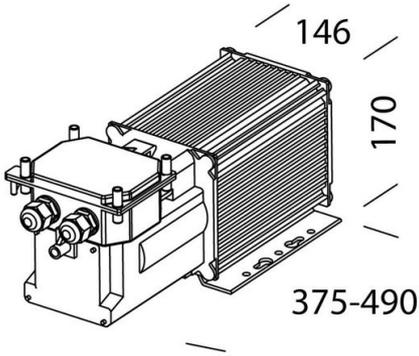
in alluminio. Contenente: alimentatore e condensatore di rifasamento;(senza accenditore)
