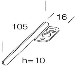
in acciaio zincato. Set di 4 pezzi da utilizzarsi nel caso le comfort non vengano installate in appoggio.
