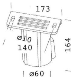
in alluminio pressofuso, per l'installazione su palo diametro 60 in versione bilampada.
