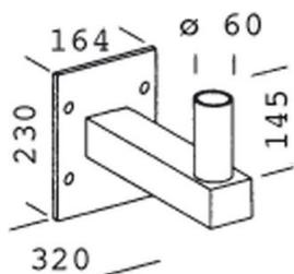
in acciaio tropicalizzato con piastra di fissaggio. Permette l'installazione a parete.
