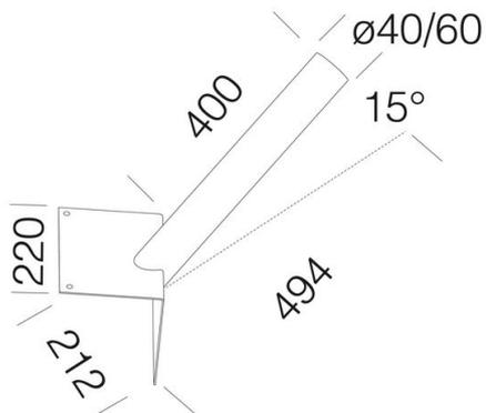
in acciaio tropicalizzato. Permette l'applicazione su parete ad angolo. Inclinazione 15°.
