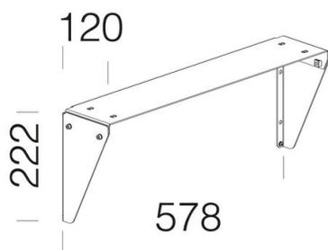
In lastra di alluminio verniciata; da utilizzare su Forum 2.0 con fasci simmetrici; installare sui singoli moduli per un controllo più accurato dello spill light. A richiesta: prolunga schermante per deflettore (richiedere in sede).
