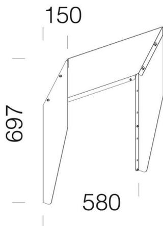
In lastra di alluminio verniciata; da utilizzare su Forum 2.0 con fasci asimmetrici per il controllo più accurato dello spill light.
