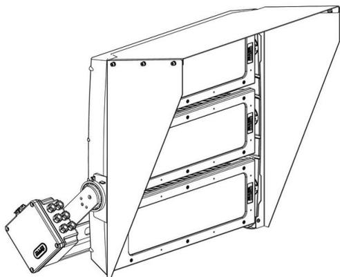
in acciaio. Permette di schermare il fascio luminoso.
