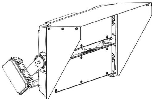
in acciaio. Permette di schermare il fascio luminoso.
