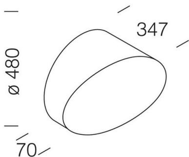
in acciaio. Permette di convogliare il fascio luminoso in un'unica direzione. Può essere installato con l'acc. 111.
