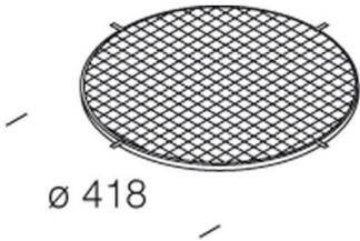
In tondino di acciaio zincato. Per la protezione antiurto. Può essere installato con l'acc. 112.
