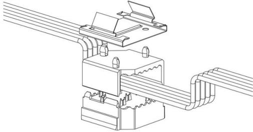
in policarbonato. Da utilizzare per installare un corpo illuminante aggiuntivo al canale elettrificato art. 6001/6002/6003.
