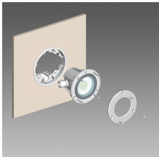
in nylon f.v. da utilizzare per incassare Microfloor a parete
