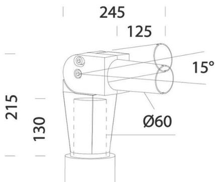
in alluminio. Da utilizzare per l'applicazione su pali con terminali Ø60. Da utilizzare sempre sui pali 1477/1478 e 1485/1487.
