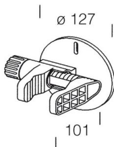
in nylon f.v. Permette di applicare Koala/Dafne su diverse superfici senza doverlo fissare definitivamente. Apertura del morsetto da min. 20 a max 60 mm.
