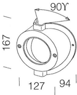
in nylon f.v. Permette l'installazione su una superficie ad angolo esterno.
